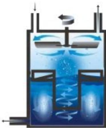
Перемешивание культуральной среды в биореакторе осуществляется воздушным вихрем за счет разницы давлений в его центре и на периферии и трения воздушного потока о поверхность жидкости. Возможность подключения эрлифта увеличивает скорость вертикальной составляющей движения жидкости за счет увлечения ее вверх всплывающими пузырьками воздуха. При работе с активными аэробами и/или с вязкими средами дополнительное использование эрлифта, дает возможность значительно
